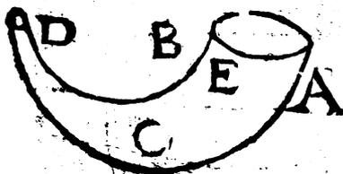
Sia vn vaso fatto a modo di vn corno A B C D, & sin A B la parte più larga, la più stretta D, dico, che il vaso A B C D sia pieno d'acqua, nõ perche la A B sia la parte più larga, quella parte di acqua contenuta in essa, sforza l'acqua C D, e la costringe a salire, e sforzare l'acqua, che stà nella sua se-
